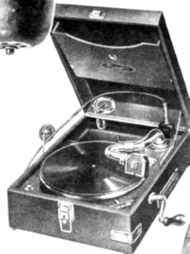
Koffersprechmaschine wahlweise durch Federwerk oder Elektromotor anzutreiben und mit akustischer Abtastdose oder elektrischem Tonabnehmer zu verwenden. (Triumphon)
