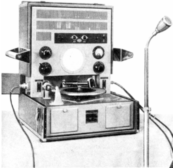
Vollständige Koffer - Schneideinrichtung mit Verstärker, Mikrophon und Lautsprecher, wie sie von der Deutschen Reichspost für die Sprechbrief-Aufnahmen benützt wird. (Lorenz)
